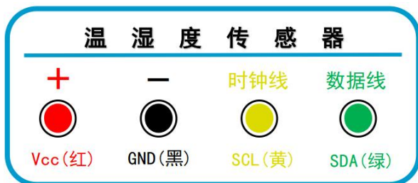
Vcc: 电源 (红色); GND (黑色); SCL (黄色或者白色); SDA (绿色或者蓝色)
